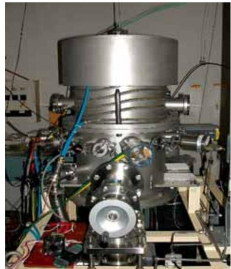
図2 インバータープラズマ装置外観
